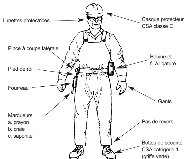
Figure 1.1 : Ferrailleur prêt pour la pose d'acier d'armature
